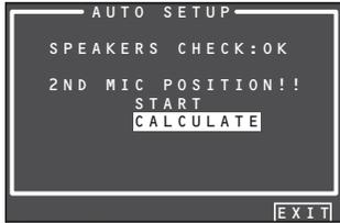
9. Wiederholen Sie Schritt 7 und 8 so oft, bis Sie Messungen an 6 Positionen zwischen der Haupthörposition und der Umgebung ausgeführt haben. Nach Abschluss aller Messungen erscheint die nachstehend abgebildete Bildschirmanzeige.
