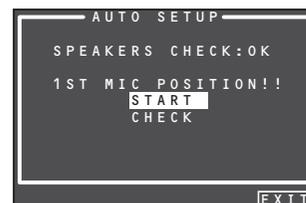
Um die Ergebnisse der Lautsprecherprüfung anzuzeigen, betätigen Sie die Cursortaste **▲** oder **▼** zur Wahl von „**CHECK**“, und drücken Sie dann die **OK/ENTER**-Taste. Daraufhin werden die Messergebnisse auf dem Bildschirm angezeigt.
