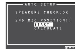
8. Stellen Sie das Mikrofon an der zweiten Position auf, betätigen Sie die Cursortaste ▲ oder ▼ zur Wahl von „START“, und drücken Sie dann die OK/ENTER-Taste, um die Messung für die zweite Hörposition auszuführen. Zu diesem Zeitpunkt können Sie die Messung für die zweite Position abbrechen und die Messergebnisse berechnen lassen, indem Sie „CALCULATE“ mit den Cursortasten markieren und dann die OK/ENTER-Taste drücken.
