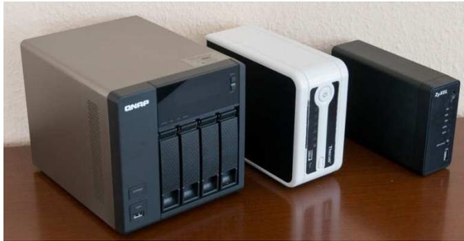
Im Bildchen sind drei unterschiedliche NAS zu sehen. Von links nach rechts eine NAS mit 4 HDD-Plätzen, dann eine NAS mit 2 HDD und rechts eine "Single-Version".
