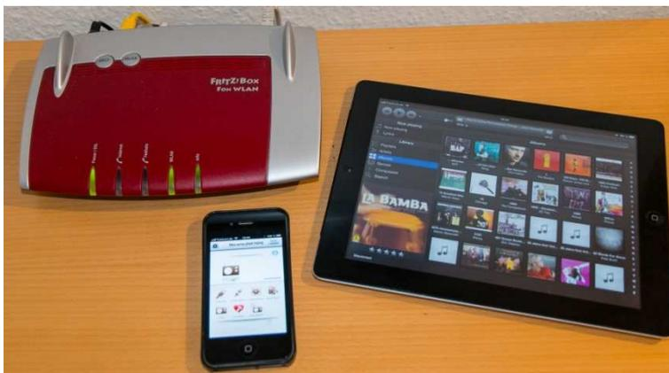
Im Bild wird mit dem iPad das Notebook bedient, das iPhone bedient den Marantz. Dabei verbinden sich die Handgeräte per WLAN mit dem Router und der gibt die Steuerbefehle entweder per WLAN oder LAN an die Geräte weiter. Dadurch ist auch eine Fernbedienung vom Nebenzimmer möglich oder das Gerät steht im geschlossenen Schrank. Man benötigt keinen "Sichtkontakt"
