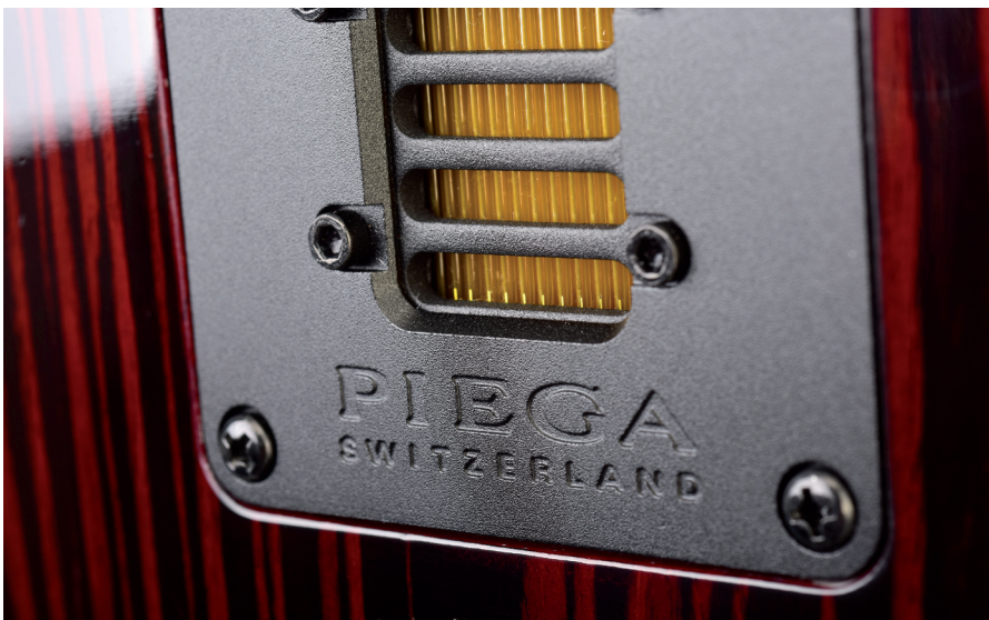
Im Vergleich zu den klassischen Magnetostaten in anderen Piegas setzen die „kleinen“ Classic-Modelle auf einen Air-Motion-Transformer. Die magnetostatische Membran ist Ziehharmonika-artig gefaltet und bietet so eine größere effektive Membranfläche.
