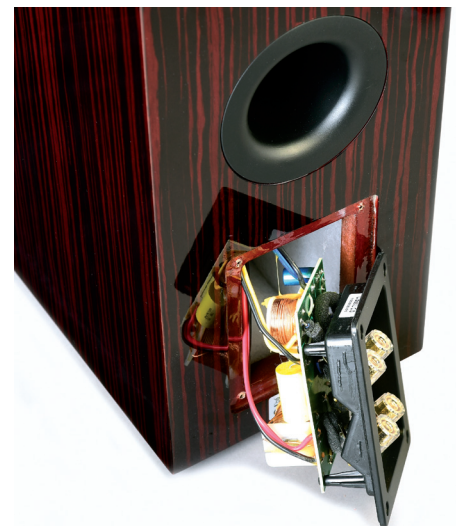
Das Terminal bietet eine Bi-Wiring-Option, die 2,5-Wege-Weiche ist mit hochwertigen Luftspulen und Folienkondensatoren bestückt.
