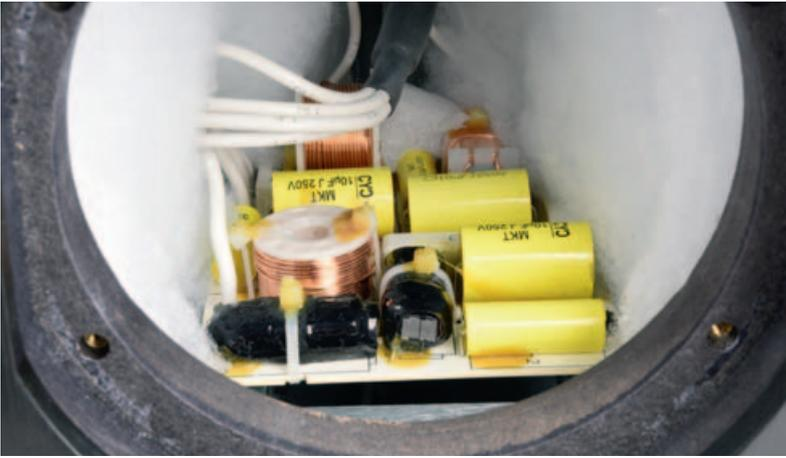
Eine komplett neue Weiche. Piega nutzt Kernspulen und hochwertige Bauteile. Die Bässe laufen bis 600 Hertz, ab 3500 Hertz springt der Hochtöner an.
