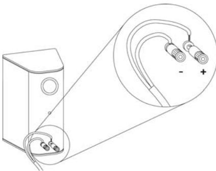
Die Litzen vollständig durch die Öffnung führen.
