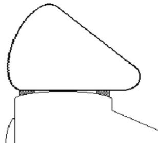
Auf TV-Gerät mit gewölbtem Gehäuse sollte der Lautsprecher, ohne Gestell, mit den beigelegten durchsichtigen Bumpons positioniert werden. Zur Erhöhung der Rutschfestigkeit sollten diese an das Lautsprechergehäuse geklebt werden.
