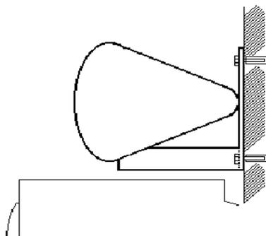
Mit den beigelegten Dübeln ist eine Montage direkt an die Wand möglich. Dazu verwenden Sie bitte einen Steinbohrer der Grösse 8mm.
