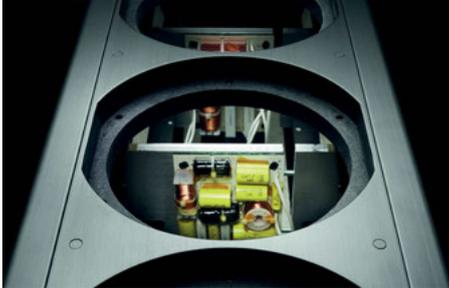
Die Frequenzweiche der Standbox ist recht komplex ausgefallen. Piega verwendet erkennbar nur sehr hochwertige Bauteile.
